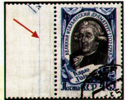
Рис. 8 Дорожки от ракеля – один из верных признаков растровой глубокой печати
